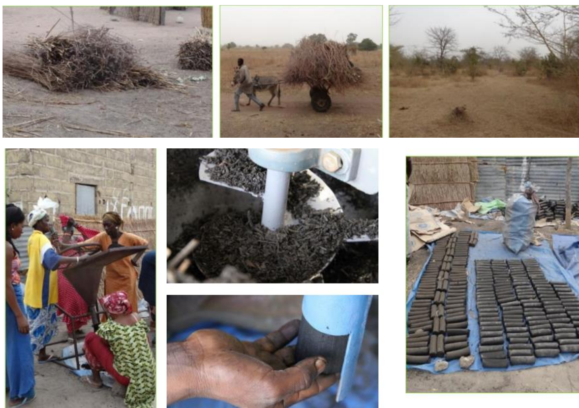
Figure 22. Processus de fabrication de biocharbon produit par l'ONG NEBADAY
